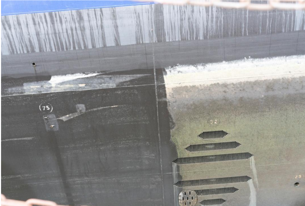
Abb. 9: „Polarstern“ nach Reinigung im Dock, gereinigte Fläche links, ungereinigt rechts
