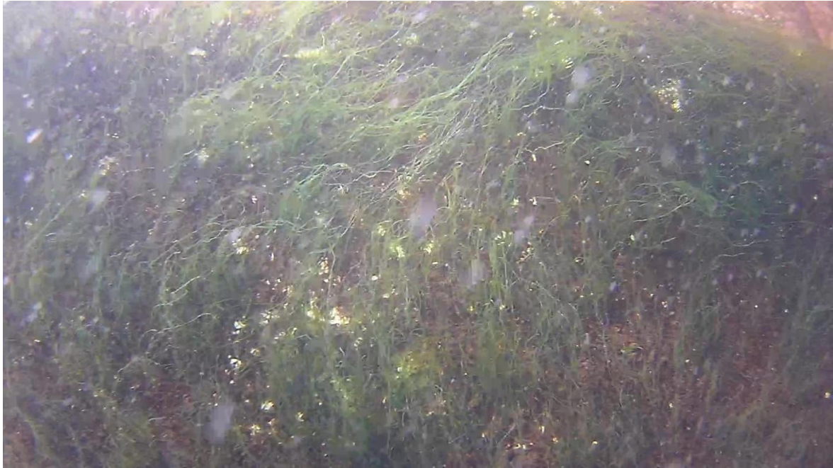
Abb. 21: Testbeschichtung von Momentive/Wohlert auf der „Wega“ im April 2019, 2 Jahre nach der letzten Reinigung mit fädigen Grünalgen und vereinzelten Seepocken, BSH
