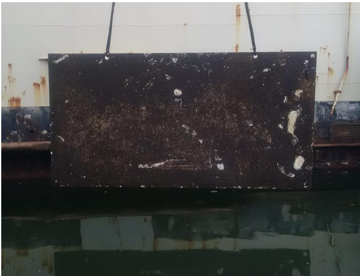
Abb. 43: Stahlplatte nach 7 Monaten Exposition vor der Reinigung
