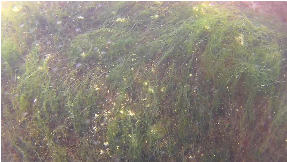
Abb. 22: Testbeschichtung von Momentive/Wohlert auf der „Wega“ im April 2019, 2 Jahre nach der letzten Reinigung mit fädigen Grünalgen und vereinzelten Seepocken, BSH
