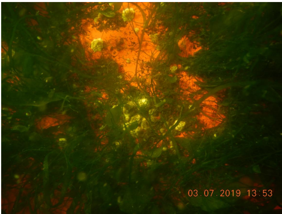
Abb. 16: Reinigungsfähige Beschichtung von Jotun auf der „Wega“ im Juli 2019, mit dichtem Bewuchs aus fädigen Grünlagen und vereinzelten Seepocken, vor der Reinigung, DG Diving
