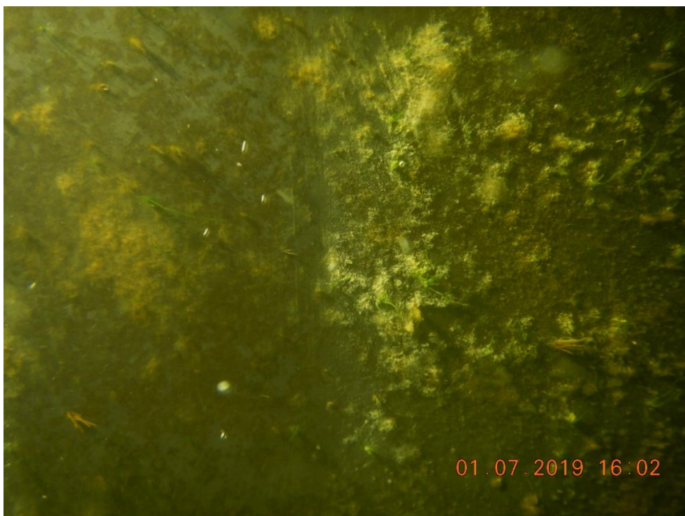
Abb. 3: Bewuchs mit Biofilm und fädigen Grünalgen Heckbereich „Polarstern“ am 1.7.2019 vor der Reinigung, DG Diving
