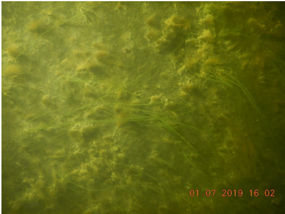
Abb. 2: Bewuchs mit Biofilm und fädigen Grünalgen Heckbereich „Polarstern“ am 1.7.2019 vor der Reinigung, DG Diving
