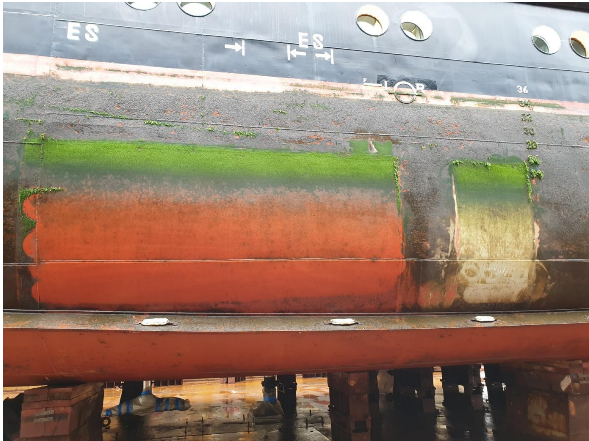
Abb. 20: Reinigungsfähige Testbeschichtungen auf der „WEGA“ nach der Unterwasserreinigung im unteren Drittel, im Juli 2019, links Jotun, rechts Momentive/Wohlert
