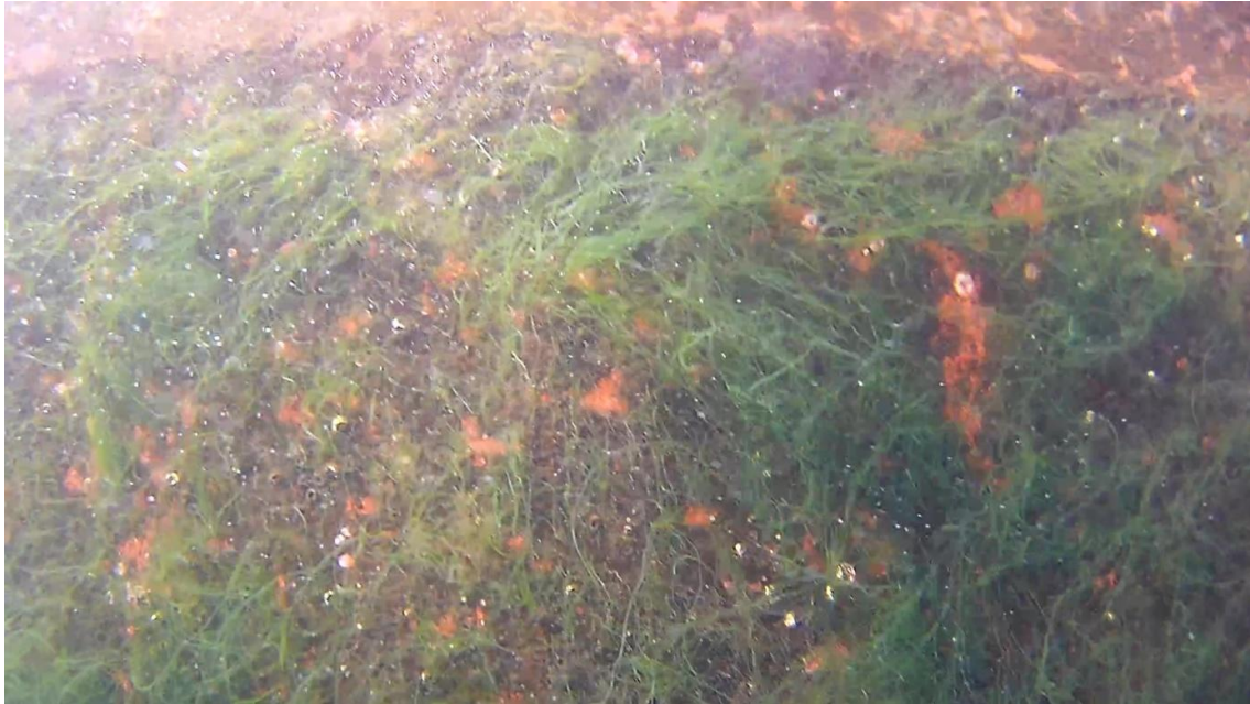
Abb. 15: Reinigungsfähige Beschichtung von Jotun auf der „Wega“ im April 2019, mit dichtem Bewuchs aus fädigen Grünlagen und vereinzelten Seepocken, letzte Reinigung März 2017, BSH
