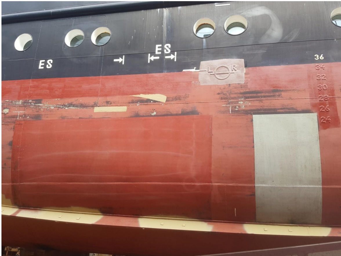
Abb. 26: Testbeschichtungen auf der „WEGA“ Juli 2019 nach vollständiger HD-Reinigung im Dock, links Jotun, rechts Momentive/Wohlert
