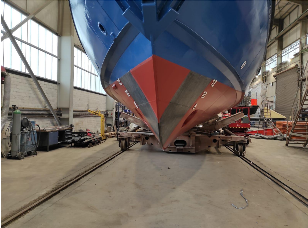
Abb. 35: „W5“ nach Applikation von Overdrive im Bugbereich
