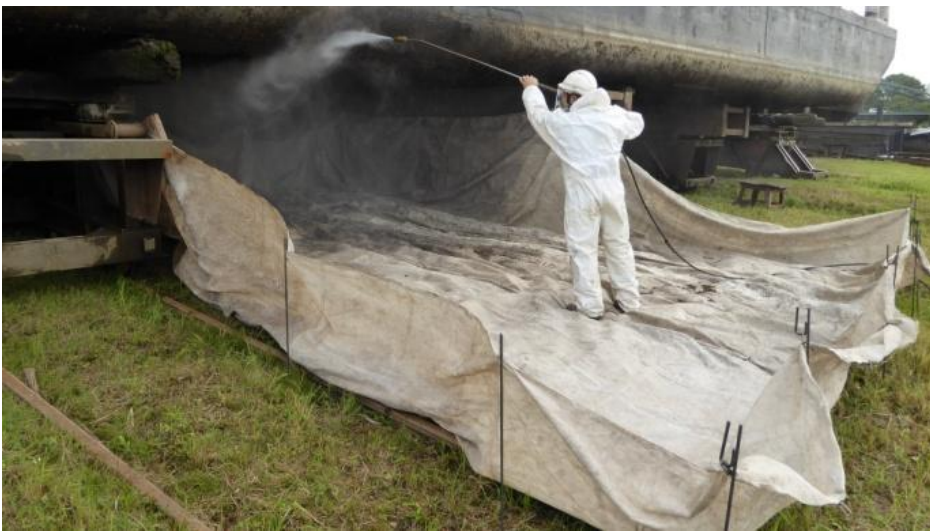
Hochdruckwaschen mit einem Vlies als Gewässerschutz (Quelle: LLUR-SH)
